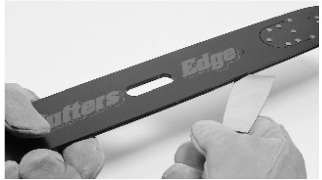
Fig. 27. Cleaning bar groove
